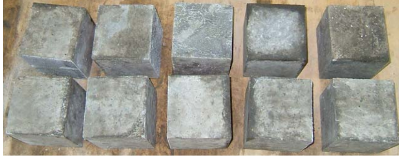
Şekil 1. Priz hızlandırıcı kimyasal katkı maddesi ile hazırlanan numuneler
