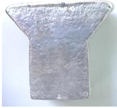
Şekil 2. Replicast CS yöntemi ile dökülen parçanın görüntüsü
