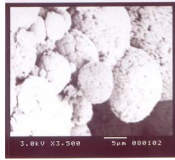
Şekil 4. PEG 4000-sodyum akrilat esaslı kopolimerin SEM mikrografı
