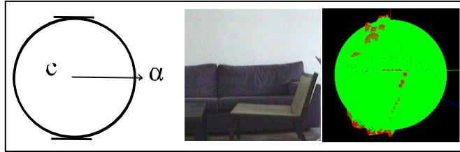
Şekil 1. Solda: x = [c \ \alpha]^T noktasında bulunan bir robot; Ortada: Sadece bir izleme yönü f' 'den yerin görünümü; Sağ: N_S = 100 odaklanma sonunda bir görsel filtreye olan yanıt kullanılarak elde edilen baloncuk yüzeyi.
