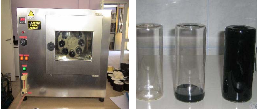
Şekil 2. Dönel ince film etüvü ve deney öncesi ve sonrasında şişelerin durumu
