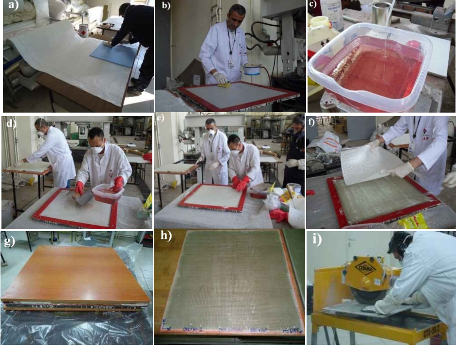
Şekil 2. Üretim aşamaları a)Kumaş kesimi, b)Kalıp vakslama, c)Matriks karışımı hazırlama, d)Karışımın kalıba dökülmesi, e)Tek kat kumaşın yerleştirilmesi, f)Son kat kumaşın yerleştirilmesi, g)Üst kalıbın kapatılması, h)Ürün, i)Üründen numunelerin kesilmesi
