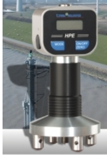
Şekil 3. HPE II Barcol Sertlik Ölçme Cihazı
